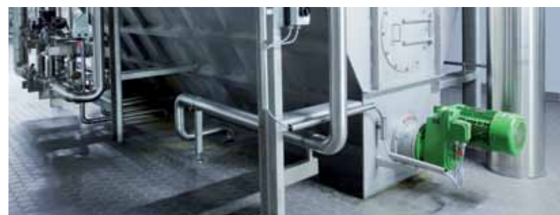
Ein Flachgetriebe dient dem Antrieb der Förderschnecke und dem Austrieb des Trebers.
