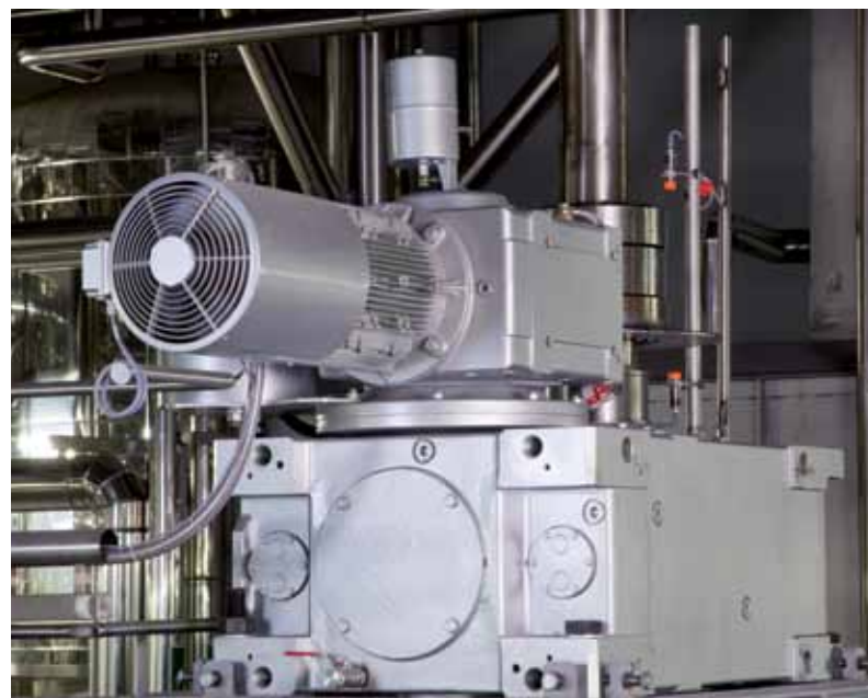
Gesteuert wird der Läuterprozess von einem einzigen Motor: Über ihn läuft sowohl das Auflockern und Durchschneiden des Trebers als auch das Austrebern, also das Ausräumen des Bottichs nach Abschluss des Vorgangs.
