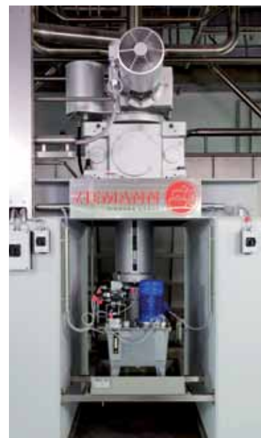
Gesteuert wird der Läuterprozess von einem einzigen Motor: Über ihn läuft sowohl das Auflockern und Durchschneiden des Trebers als auch das Austrebern, also das Ausräumen des Bottichs nach Abschluss des Vorgangs.
