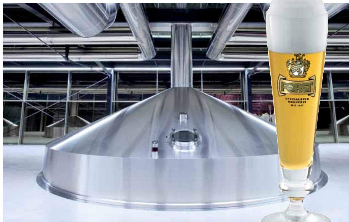
Der im Durchmesser 8,6 m große Läuterbottich ist das Herzstück des Sudhauses.
